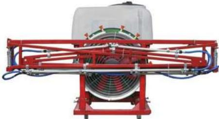
**Описание:** Насос опрыскивателя приводится в действие от ВОМ трактора и подает жидкость под давлением на форсунки, установленные на вентиляторе машины. Приводимый в действие пропеллер под давлением создает струю воздуха на поле. Направление струи воздуха можно регулировать с помощью крыльев. Этим опрыскивателем можно эффективно опрыскивать посаженные в два ряда фруктовые деревья любого типа высотой 8-12 метров, виноградники и посевные площади.
