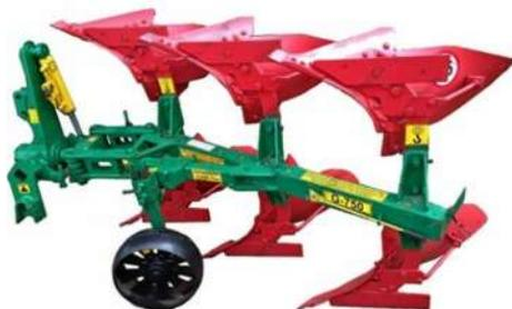
**Описание:** Плуг 3-х корпусный навесной оборотный ПОН-3-35 Предназначен для гладкой пахоты на глубину до 27 см не засоренных камнями, плитняком и другими включениями почв, с удельным сопротивлением до 0,09 МПа и твердостью до 0,4 МПа.
