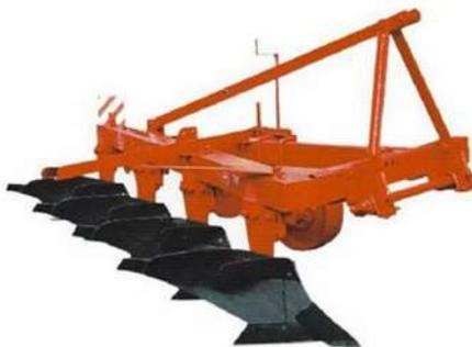
**Описание:** Плуг 4-х корпусный навесной ПЛН-4-35П (ПЛН-4-35П-2) предназначен для пахоты почв под зерновые и технологические культуры на глубину до 35см, не засоренных камнями, плитняком и другими препятствиями, с удельным сопротивлением до 0,1 Мпа (1,0 кгс/см<sup>2</sup>).
