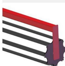
СИСТЕМА ОПОР И КАТКОВ
